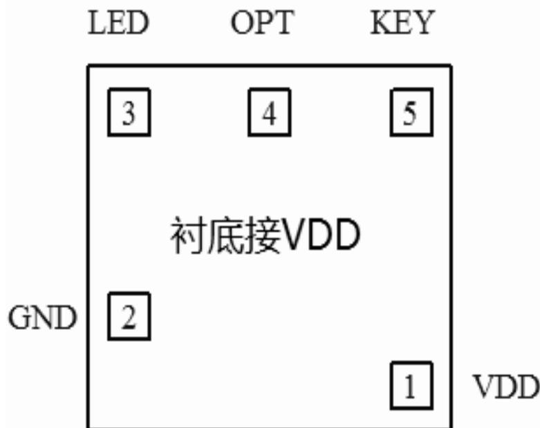
备注: IC 底座接接 VDD, IC 尺寸 850UM\*900UM
