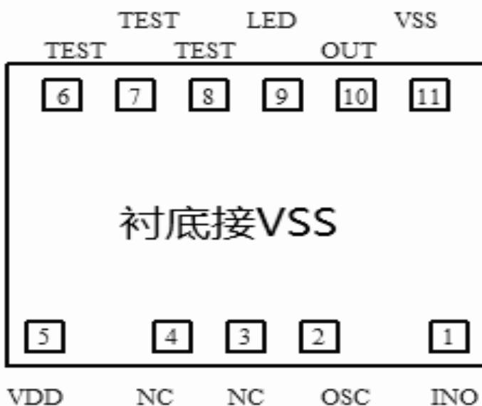
备注: IC 衬底接 GND, IC 尺寸为 1000\*1100UM
