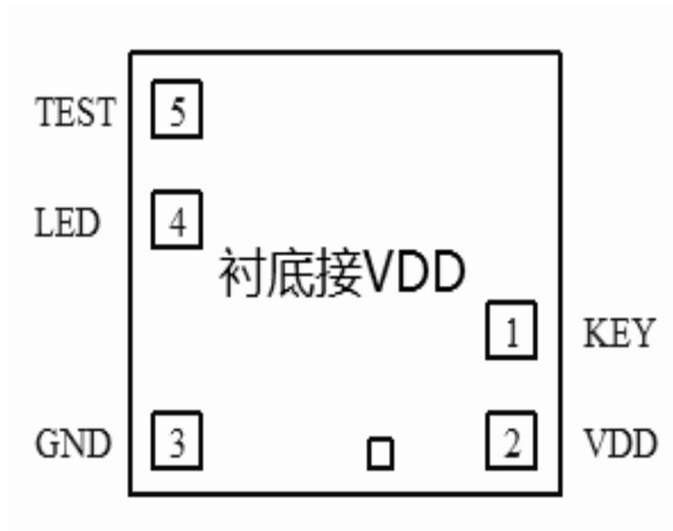
注: IC 底座接 VDD,IC 尺寸 900UM\*1000UM
