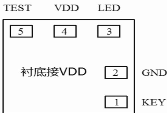
注: IC 底座接 VDD,IC 尺寸 900UM\*1000UM
