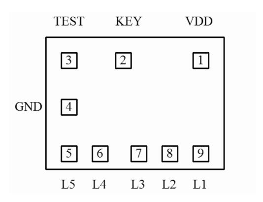
备注: IC 底座接接 VDD, IC 尺寸 1300UM\*1200UM
