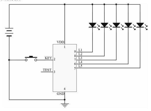
注: 1,因 IC 的输出电流比较大,需加限流电阻,电阻的大小视情况而定。 2.以上电路仅供参考,如有修改,恕不另行通知!
