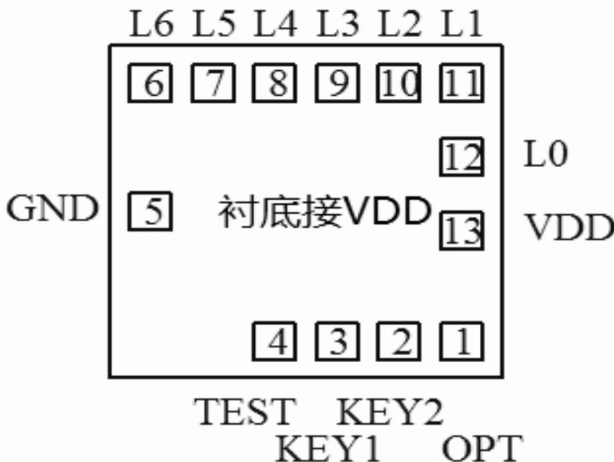
注：IC 底座接 VDD,IC 尺寸 900UM\*1000UM
